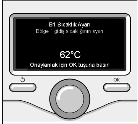
Isıtma sıcak su sıcaklık derecesini değiştir
